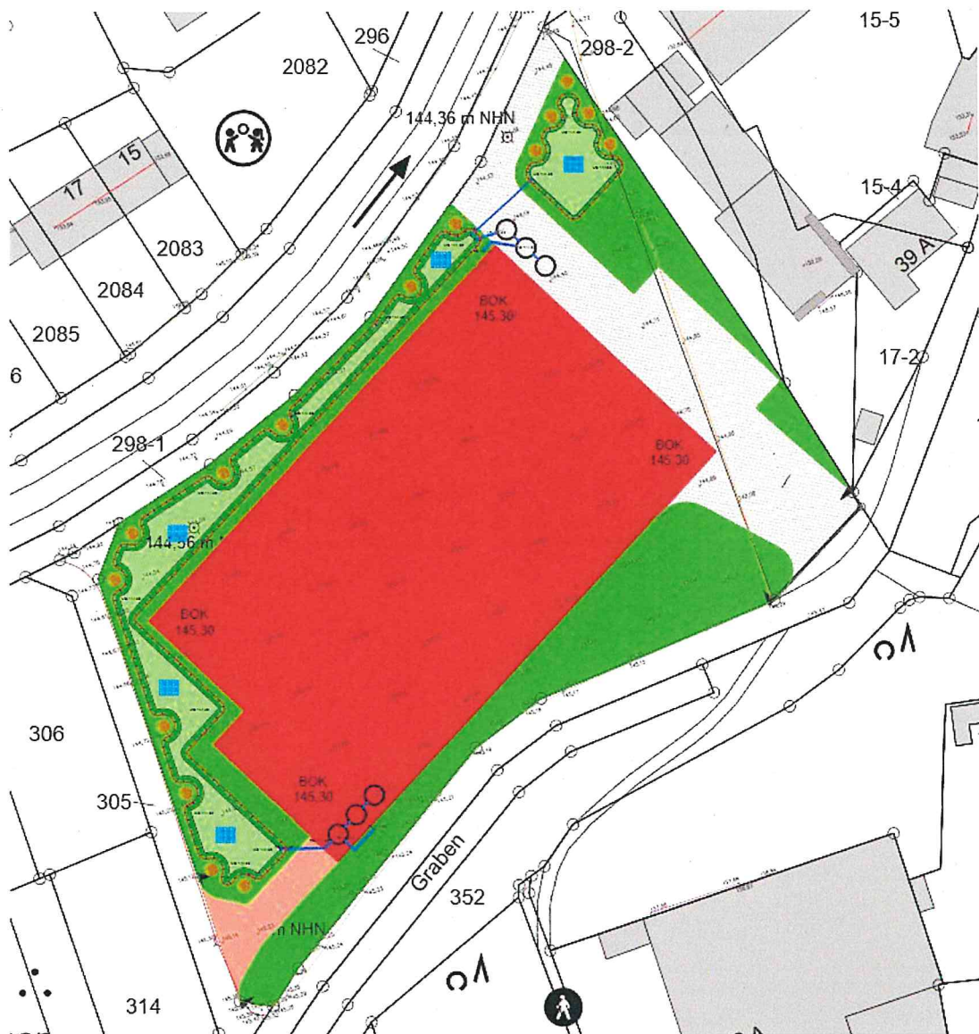
Entwässerungsplanung mit beispielhaftem Pflanzschema für Pflanzungen von Bäumen I. Ordnung (rote Kreise) in den Flächen M1a und M1b (Quelle: SEILER - Ingenieure & Architekten GmbH, Alzey 02/2022)
